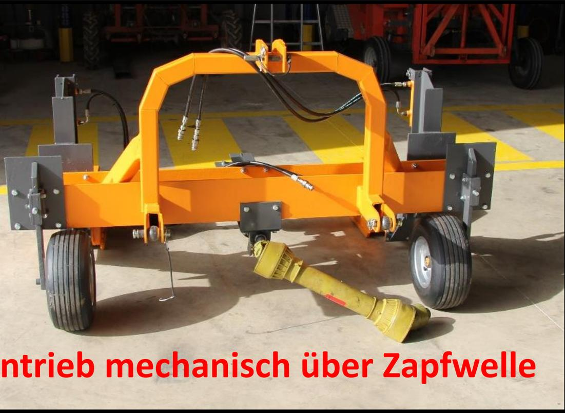
**Antrieb mechanisch über Zapfwelle**
