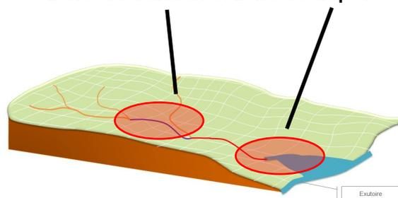
Dans le cas d'un bassin de sédimentation, l'implantation se fait plutôt « en bordure » du réseau hydrographique. Son rôle est alors le contrôle de la qualité des eaux qui rejoignent le réseau via la diminution de la turbidité et la décantation de la matière organique (diminution de l'eutrophisation).
