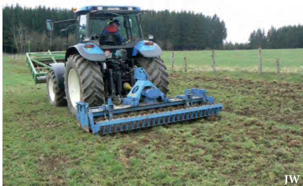
Herse rotative réglée de manière superficielle
