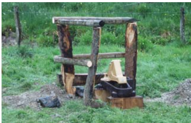
Figure 34 : Pompe à museau munie d'une protection latérale
