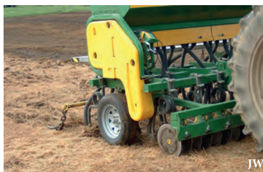
Les disques du semoir spécifique creusent des sillons dans le sol
