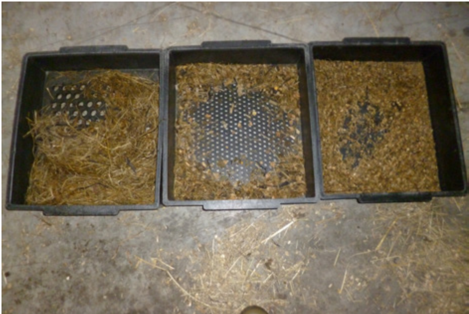
Figure 24 : Séparateur de particules muni de deux tamis
