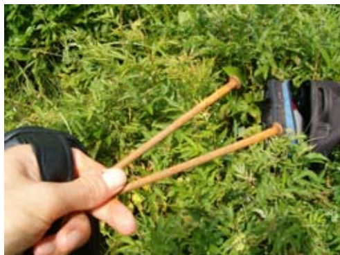
Figure 17 : Un moyen facile pour détecter la présence d'oxygène est d'enfouir des clous non zingués dans le fond du ruisseau : l'absence de formation de rouille sur les clous indique un manque d'oxygène dans le substrat.
