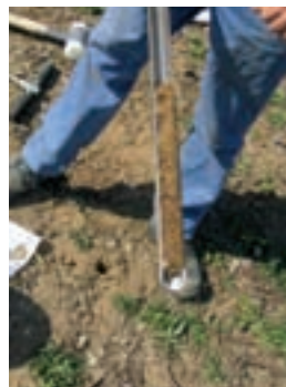
Activité principale du centre pilote Sapins de Noël : l'expérimentation tous azimuts. Ici, collecte d'un échantillon de sols pour analyse avant de commencer un essai fumures.
