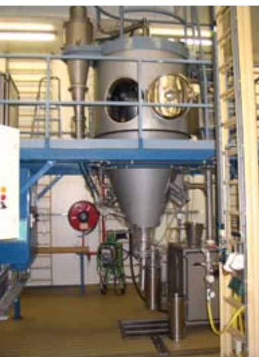
Séchoir granulateur a lit fluidisé.
