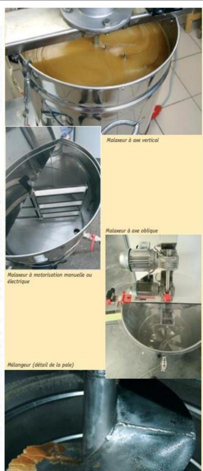
ou l'inclusion d'air possible lorsque les barres sont trop proches de la surface du miel (quelques centimètres).
