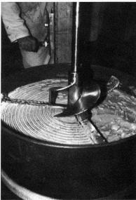
est effectué directement sur le miel cristallisé dans son emballage (fûts ou seaux). Le container est inséré dans une potence adaptée, et le miel est écrasé à l'aide d'un dispositif constitué d'une vrille centrale et de 3 barrettes latérales rayonnantes, le tout adapté à la circonférence de l'emballage et avec un système de «butée» latérale pour éviter le raclage des parois. Ce gros foret est couplé à un
