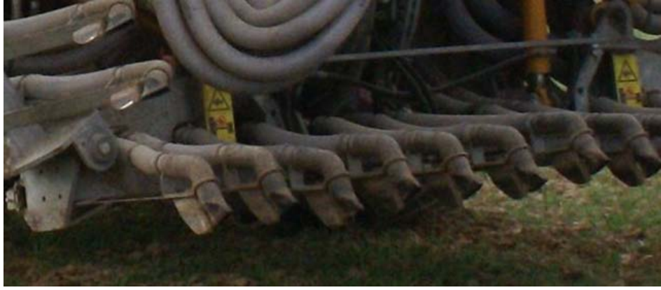
Fig. 3 : rampe d'épandage à sabots Sluismid IPSAM
