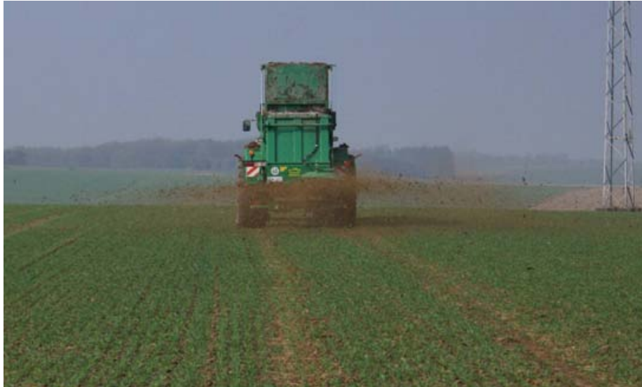
Fig. 1 : épandage des fientes avec épandeur Tebbe à plateau.
