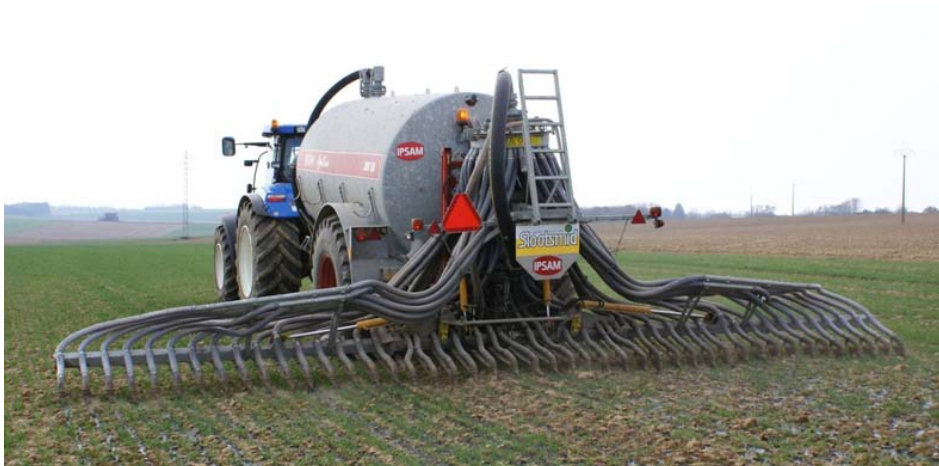
Fig. 2 : épandage du lisier de porcs à l'aide d'un tonneau IPSAM avec rampe Slootsmid.
